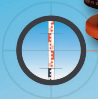
Schematische Ansicht (Originalgröße) einer Nivellierlatte aus 20 m Entfernung
